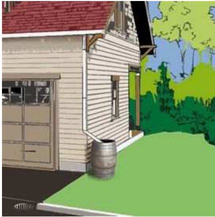
Recueillez l'eau de pluie dans un baril. Cette eau pourra servir à arroser les plantes tout en ménageant l'eau potable traitée en usine.
