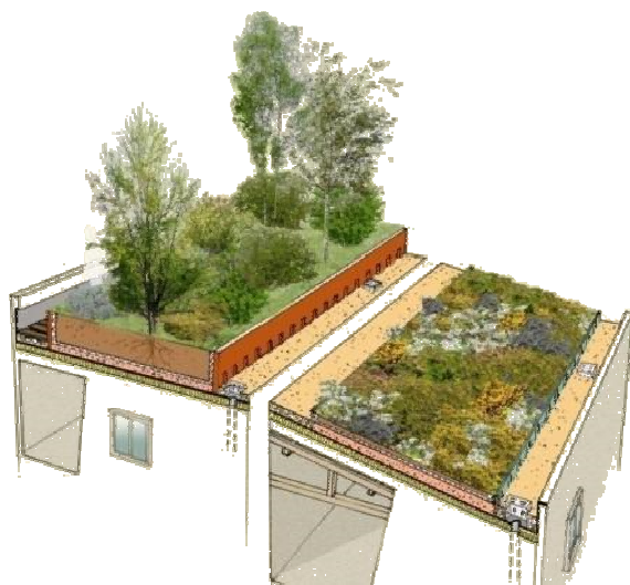
Toitures terrasse végétalisées : végétalisation intensive (à g) et végétalisation extensive (à d)
